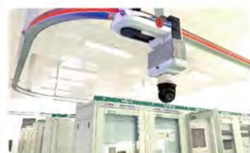
隔压站AR导轨巡检机器人系统
